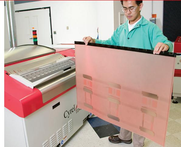
**DuPont™ Cyrel® DFR ist die harte Flexodruckplatte für den thermischen Verarbeitungsprozess, entwickelt um den höchsten Ansprüchen nach feinsten Raster-, Linien- und Vollflächen im Flexodruck gerecht zu werden.**
