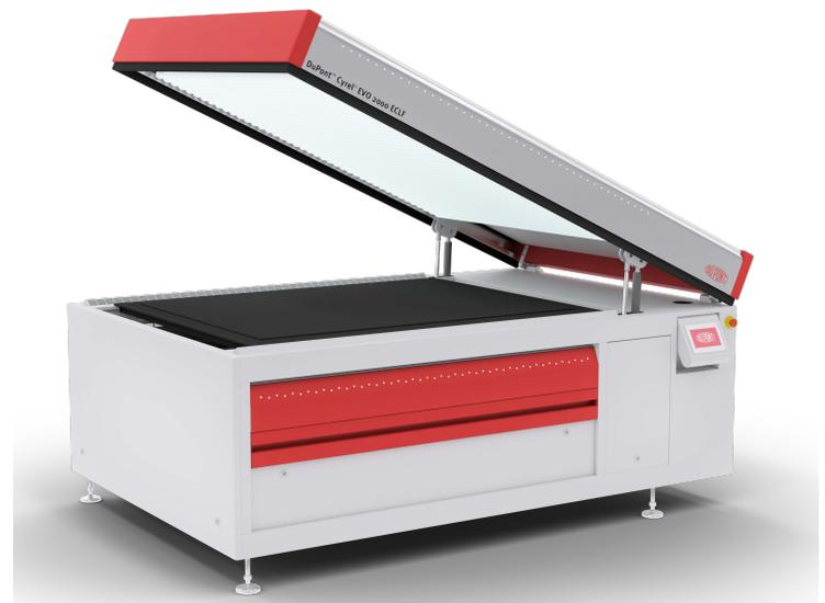
Jede Röhre wird ständig von einem Lichtleiter überwacht, wodurch der Bediener eine visuelle Anzeige erhält. In die SPS sind drei Zähler eingebettet, um die Anzahl der Betriebsstunden der UV-A- und UV-C-Röhren zu verfolgen.
