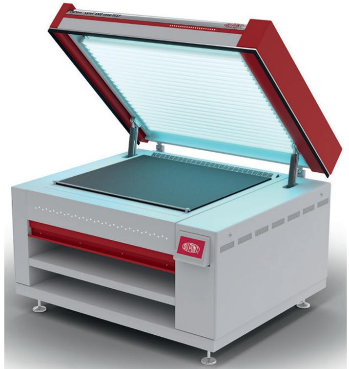
Plattenoberfläche. Einzigartig in diesem Gerät ist, das eloxierte, temperaturgesteuerte Belichterbett mit geschlossenem Regelkreis welches zu konstant gleichbleibenden Belichtungen führt. Das Gerät ist mit einem Lichtintegrator ausgestattet, der die Abnahme der Belichtungsleistung mit zunehmendem Alter der Röhren ausgleicht. Um den anspruchsvollen Anforderungen hochwertiger Platten gerecht zu werden, kann der Benutzer die 20 verfügbaren Belichtungseinstellungen individuell anpassen.
