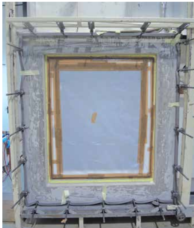
Abb. 05: DuPont™ Insta Stik™ Flex+ im Prüfstand der Holzforschung Austria
