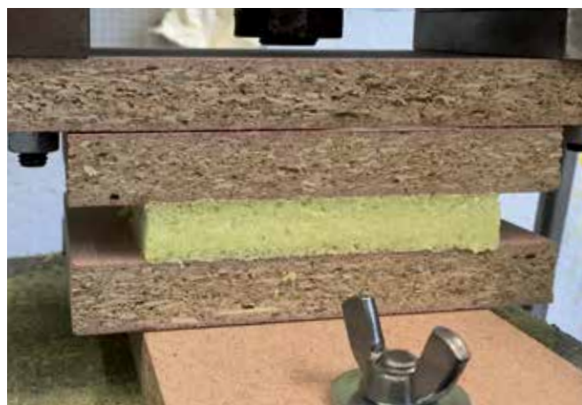
Abb. 06: Die Prüfvorrichtung zur Ermittlung der Bewegungsaufnahmefähigkeit
